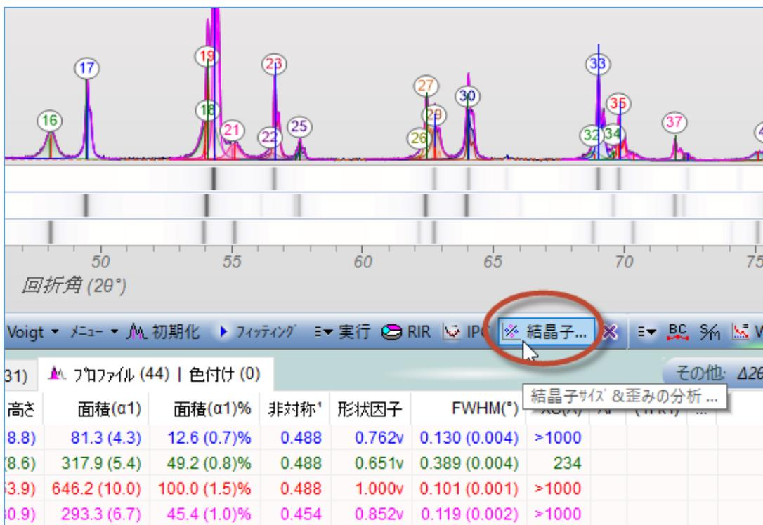
7. 結晶子サイズと歪みを見積る専用のダイアログが開きます。サンプルに複数の相が混在している場合、事前に相同定を行っておくと、このダイアログ右上でどの結晶相の結晶子サイズを推定するか選ぶことができます。
